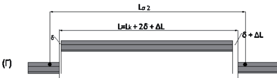
Σχήμα 4 - Κοπή της υφιστάμενης σιδηροτροχιάς για την εισαγωγή της νέας σιδηροτροχιάς
