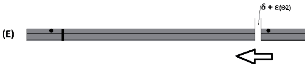
Σχήμα 23 - Συγκόλληση του ενός άκρου του αποτμήματος, προετοιμασία συγκόλλησης του άλλου άκρου
