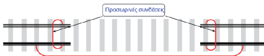
Σχήμα 2 - Αντικατάσταση και των δύο σιδηροτροχιών της σιδηροδρομικής γραμμής
