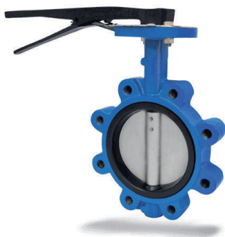
Βαλβίδα με χειρομοχλό που επιτρέπει κλείδωμα των θέσεων ανοίγματος (συνήθως ανά 15°)
