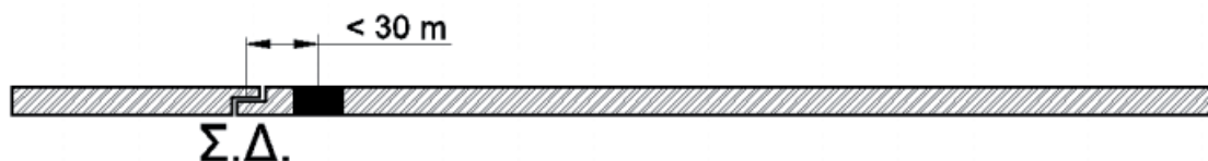
Σχήμα 9 - Σημείο θραύσης/αντικατάστασης σιδηροτροχιάς σε απόσταση < 30 m από το άκρο της Σ.Σ.Σ.
