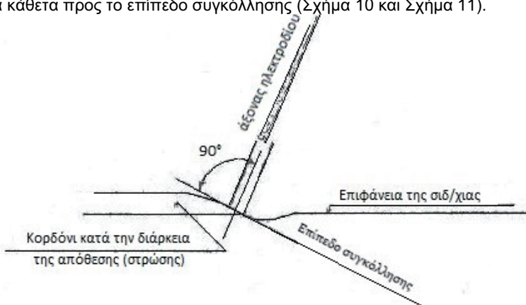
Σχήμα 10 - Διάταξη των ηλεκτροδίων
