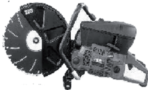
Εικόνα 1 - Δισκοπρίονο με σύστημα κύλισης
