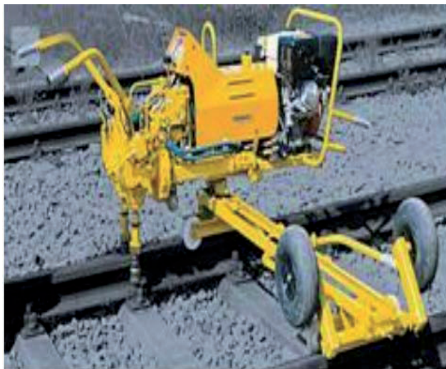
Εικόνα 1 - Μηχάνημα κοχλίωσης - αποκοχλίωσης
