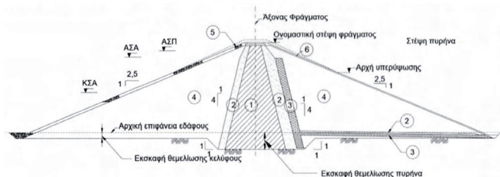
Σχήμα 1 - Τυπικό διαζωνισμένο φράγμα
