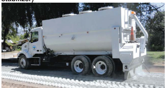
Εικόνα 3 - Όχημα διανομής τσιμέντου σε σκόνη
