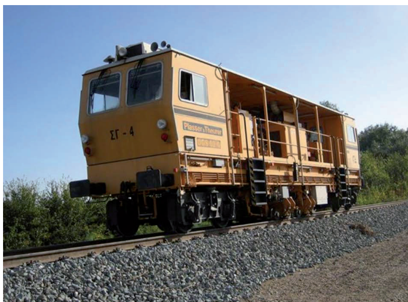
Εικόνα 3 - Δυναμικός σταθεροποιητής (σταμπιλιζάτορας) (dynamic track stabiliser)
