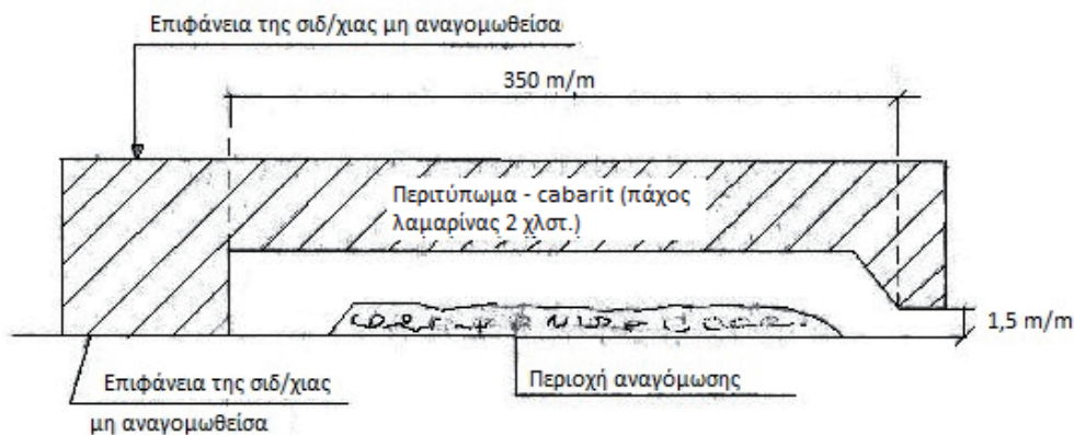
Σχήμα 8 - Τοποθέτηση περιτυπώματος - καμπαρί
