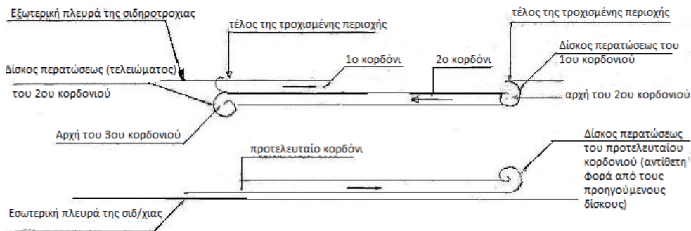
Σχήμα 6 - Διάταξη των κορδονιών
