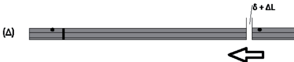
Σχήμα 5 - Συγκόλληση του ενός άκρου της σιδηροτροχιάς, προετοιμασία συγκόλλησης του άλλου άκρου
