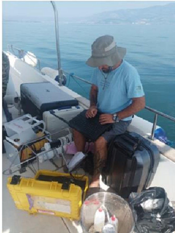
Εικόνα 6. Σύνθεση και έλεγχος στο πεδίο των δεδομένων που συλλέχθηκαν με τη χρήση CTD, θερμομέτρου καθώς και συρρόμενης υποβρύχιας κάμερας.
