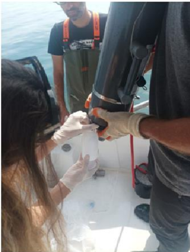
Εικόνα 3. Δειγματοληψία θαλασσινού νερού από πρότυπα βάθη με τη χρήση δειγματολήπτη τύπου Niskin
