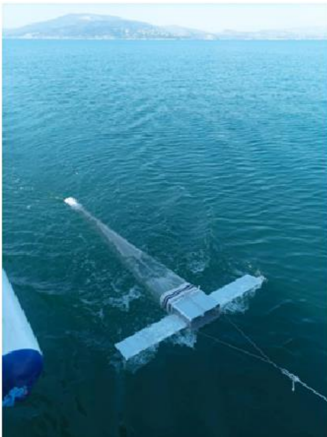
Εικόνα 5. Συλλογή μικροπλαστικών από την επιφάνεια της θάλασσας με δειγματολήπτη τύπου Manta.
